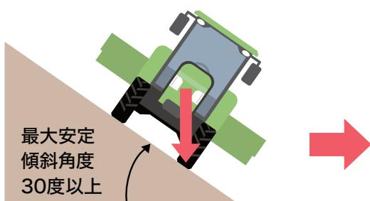
※車両総重量が車両重量の1.2倍以上又は、積載により重心高さが上がるものは最大安定傾斜角度35度以上
