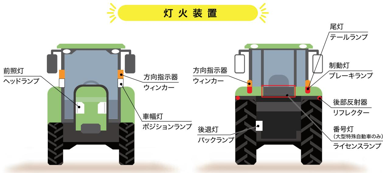
灯火装置、反射器の位置はトラクタのメーカー、シリーズ、型式により異なります。
